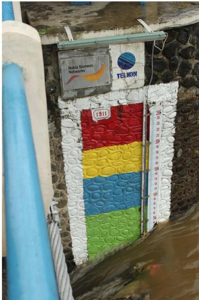
Gambar 2.5 Sistem Pengukuran Ketinggian Air Bendung Katulampa.
