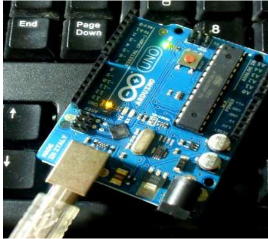
Gambar 2.5 Komponen LED yang terdapat pada board Arduino Uno
